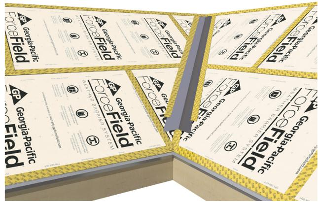
1. Con ForceField Premium Tape, centre la cinta sobre la unión del limahoya donde se unen los paneles del techo.
