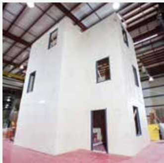
Essai 1 : Système d'enveloppe de bâtiment WRB-AB
