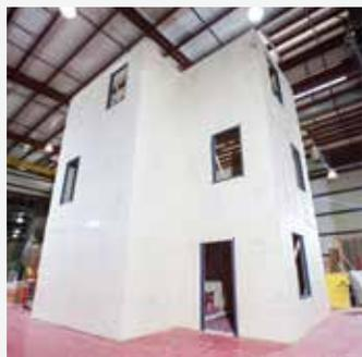
Ensayo 1: Sistema WRB-AB para aislamiento de edificios
