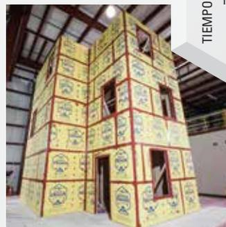
Ensayo 3: Sistema de barrera DensElement®
