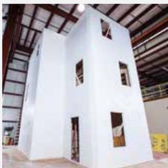
Ensayo 2: Sistema WRB-AB de membrana de aplicación con fluidos
